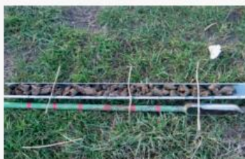
Gouttière, tarière pédologique et marqueurs
